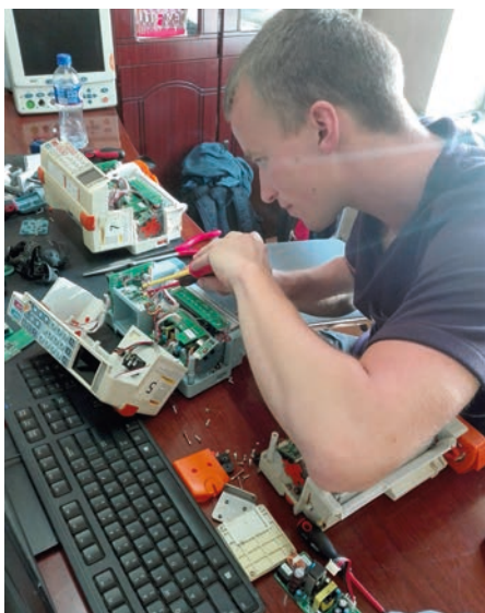
Alexander samler en funktional infusionspumpe med dele fra defekte pumper.
